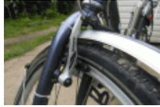
V-Brake Bremse Shimano
