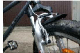
V-Brake Bremse Shimano
